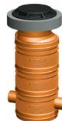
**Колодцы KK 1000** – применяются на магистральных трубопроводах для подсоединения труб диаметрами DN 110 – 600 мм. Вход в колодец может быть выполнен как под бетонную плиту, так и под применение телескопа – трубы DN 630 мм с возможностью установки чугунного люка класса D400.
