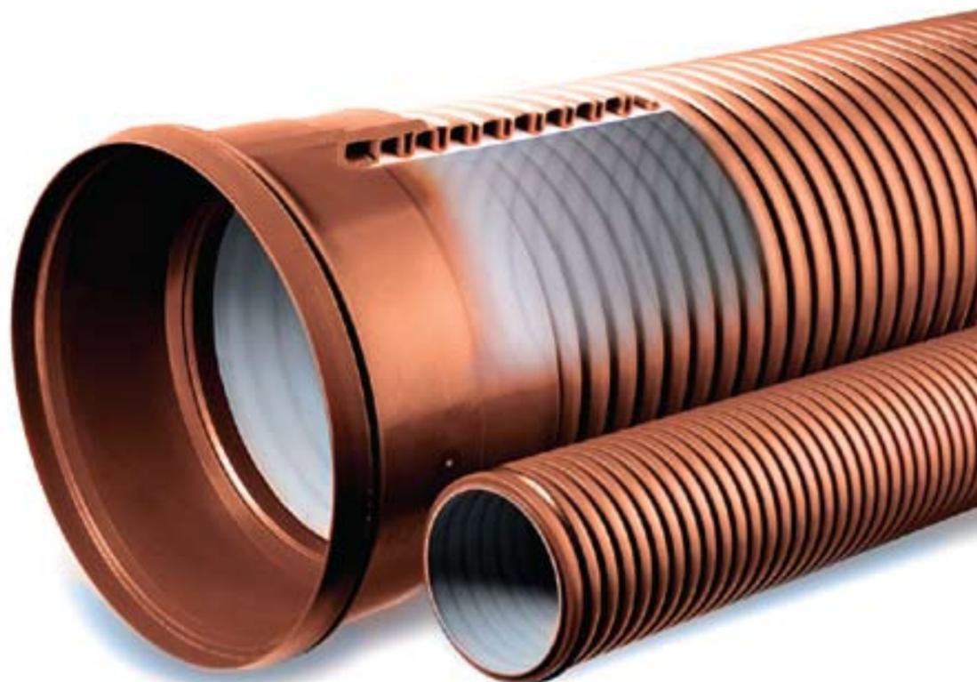
**Pragma®** и **Pragma® PR016** – раструбная труба с двойной структурированной стенкой, предназначенная для строительства безнапорных систем водоотведения. Трубы производятся из полипропилена-блоксополимера. Метод производства, двойная соэкструзия, когда одновременно изготавливаются внутренняя и наружная стенки, образующие на выходе из экструдера единое целое.
