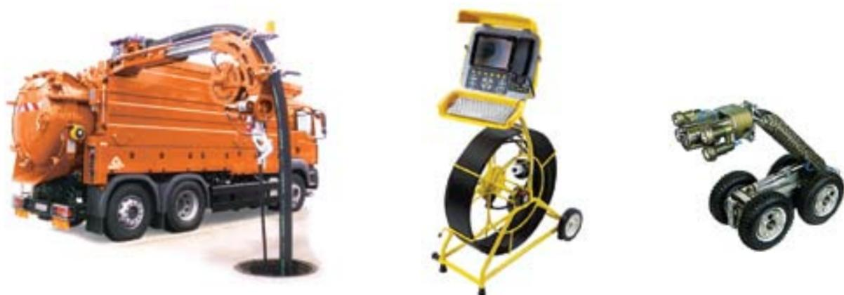
При обслуживании системы колодцев Прагма® с помощью телеинспекции и гидромашин нет необходимости в нахождении человека внутри колодца, т.к. все операции проводятся с поверхности земли.
